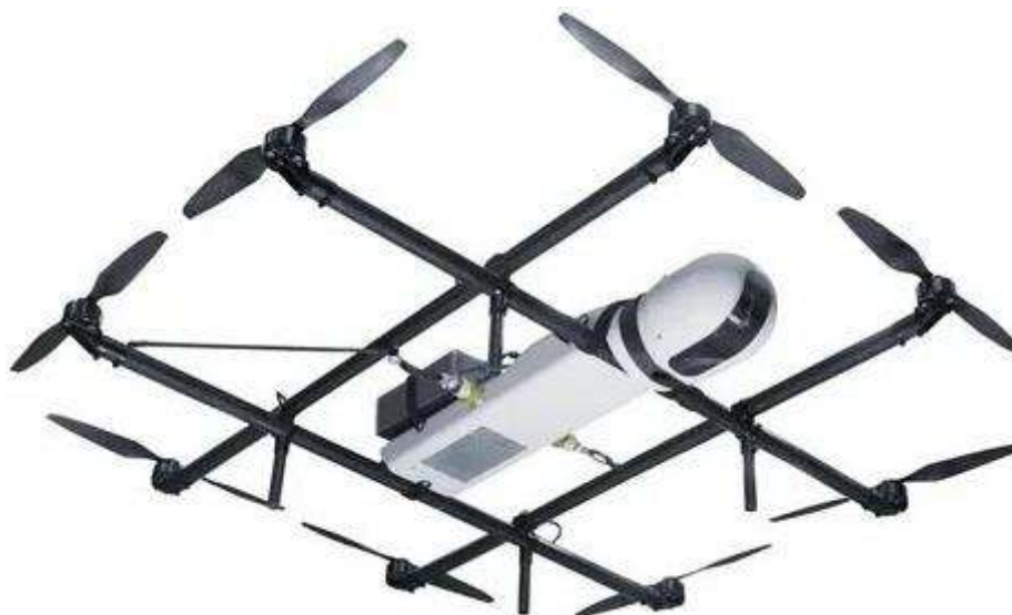
Рисунок 19 - ZALA 421-22 (Россия) — вертолётного типа БПЛА, используемый в РЭБ и разведке.
